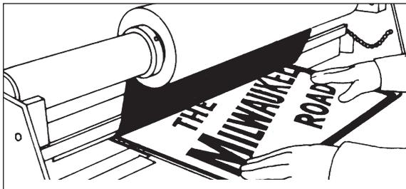
6. Die kaschierten Folienbogen werden direkt hinter der Maschine abgetrennt.
